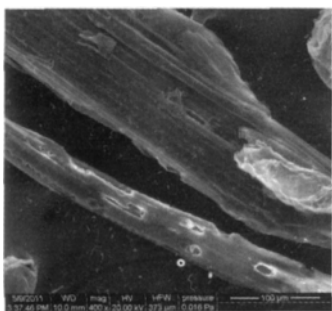
图2 小麦茎秆纤维素的扫描电镜(SEM)照片
